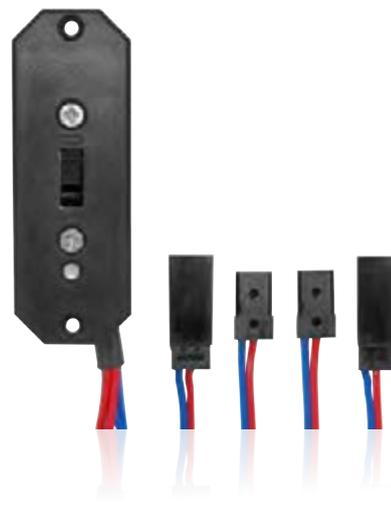
Wie auch beim **Powerschalter** wird ein hochwertiger Schalter mit schwimmend gelagerten Kontakten verwendet, der auch bei starken Vibrationen eine hundertprozentige Schaltverbindung herstellt. Alle Teile in der Weiche sind auf einer Platine verlötet. Die Kabel werden mit innenverklebtem Schrumpfschlauch knickgeschützt aus dem Gehäuse geführt, um selbst stärksten Vibrationen standzuhalten.
