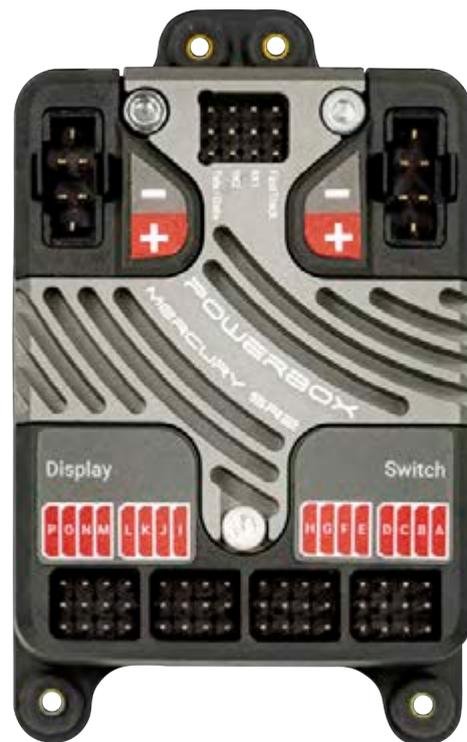
Die Ausgangsspannung der **PowerBox Mercury SR2** ist geregelt und kann auf 6.0V oder 7.8V eingestellt werden. Die Leistung der beiden Spannungsregler ist durch den gefrästen Alukühlkörper auf der Ober- und Unterseite großzügig ausgelegt und wird mit stromhungrigen Servos in 3D-Maschinen leicht fertig
